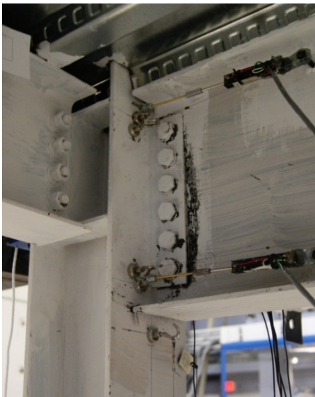
(d) Shear-Tab Conn. "A" [-0.026 rad.], HS02-160%
