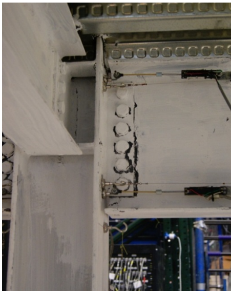
(d) Shear-Tab Conn. "C" [-0.025 rad.], HS02-160%
