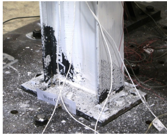
(d) West Column [0.039 rad.]; Test ID: HS01-160%
